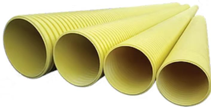
Tubería de pared estructural, fabricada en un proceso de doble extrusión, pared interior lisa y exterior corrugada. Sistema de unión mecánico, campana espigo con hidrosello de caucho.
