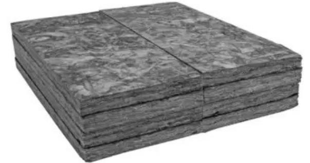
Aislamiento térmico y acústico hidrófugo de lana mineral de vidrio biosoluble aglomerado con resina termoresistente de textura uniforme, recubierta con un velo negro en una de sus caras, presentado en paneles. Está diseñado para ser empleado como aislamiento térmico en fachadas ventiladas, se adapta fácilmente a superficie irregulares.
